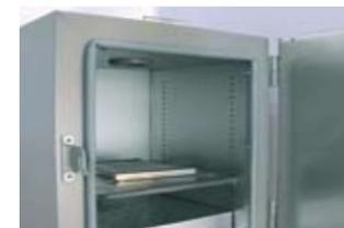
オープンによる180℃での加熱により、触媒カートリッジ内のパラジウムを再生可能です。(使用毎の加熱を推奨。加熱再生処理時交換用の触媒カートリッジのご用意を推奨。)
