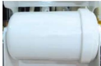
チャンバー内を満たすガスは、流入時にHEPAフィルターを通して浄化されます。チャンバー内への埃などの流入を防止し、清潔な状態を維持します。
