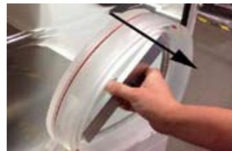
作業終了時にチャンバー内部からアームポートを密閉できるアームポートドアが付属。ドアにはOリングがありアームポートと密着するため、作業終了後も嫌気性を確保できます。
