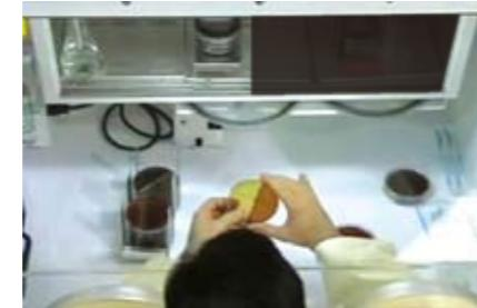
従来のグローブ式とは異なり腕を直接挿入できるため、手先を使った作業性に優れているだけでなく、グローブ式のようにグローブと腕の間に汗が付着することがないため、あらゆる面で作業時間とストレスを削減可能です。
