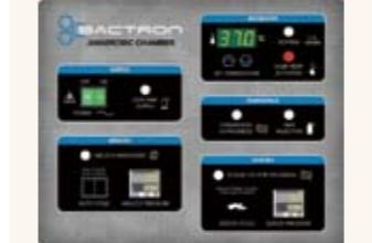
コントロールパネルには、培養庫の温度設定、エアーロック操作、各機能の動作状況を示すランプなど、常時必要な主要機能を集約。1ヶ所で簡単な操作ができます。
