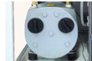
作業開始前のスリーブ内の空気吸引や、エアロックの嫌気化時に吸引するポンプは、音が静かで本体内に格納されているため、運転音は最小限に抑えられています。
