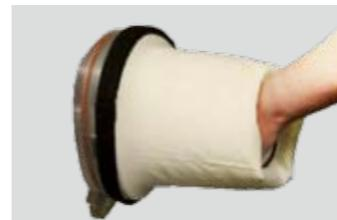
チャンバーの内圧は嫌気性確保のため一定の陽圧でコントロールされています。万一本体と腕の間に僅かな隙間が生じても影響を最小限に抑えられます。
