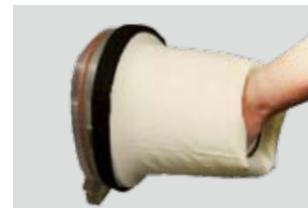
チャンパーの内圧は嫌気性確保のため一定の陽圧でコントロールされています。万が一スリーブカフと腕の間に僅かな隙間が生じても影響を最小限に抑えられます。
