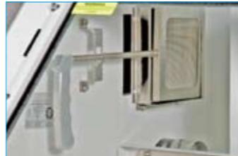
作業開始時にわずかな酸素が浸入した場合でも、チャンバー内の水素と触媒カートリッジ内のパラジウムを酸素と反応させることで水蒸気化。結露制御機能を通して処理されます。
