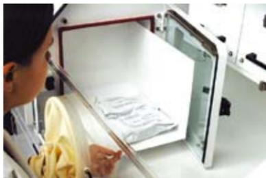
エアロックは39.6L(バクトロンEZは20.9L)の容量があり、業界内でも最大級の大きさを誇っています。また、嫌気化の所要時間も短く、最短でわずか102秒(EZは46秒)でエアロックが嫌気化されます。(サイクル数が3回の場合)
