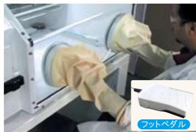
作業開始前にスリーブ内に溜まっている空気は、フットペダルを1回踏むだけでポンプによる完全自動吸引が可能。自動のため吸引量に個人差がなく、誰が使用してもチャンバー内への酸素の混入を極限まで抑えられます。
