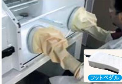
作業開始前にスリーブ内に溜まっている空気は、脚踏みペダルを1回踏むだけでポンプによる完全自動吸引が可能。自動のために吸引量に個人差がなく、誰が使用してもチャンバー内への酸素の混入を極限まで抑えられます。
