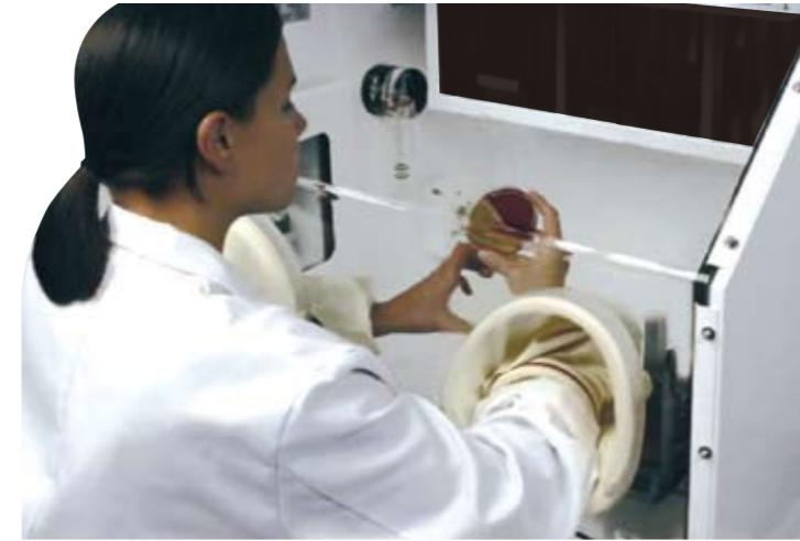
チャンバー内の培養庫と作業スペースは扉で分離されているため培養庫の温度精度が高いことに加えて、作業スペースでは室温での快適な作業が可能。外部からの備品の取り込み時間も短いなど、その機能性からバクトロンシリーズは世界の研究者に認められています。
