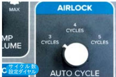
エアロックはボタンを押すだけで自動的に嫌気化されます。エアロックの空気吸引とガス充填を1サイクルとして、1回の嫌気化処理において、サイクル数を3・4・5回の中から設定可能。サイクル数が多いほど厳格な嫌気性が確保されます。
