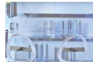
透明性が高い硬質アクリルガラスのため、歪みがなく明るい快適な視界を確保しています。チャンパー内の結露やくもりを防止する制御機能により、視界もクリアです。
