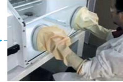
アームポートドアを閉じた状態でフットペダルを踏み、スリーブ内にたまつた空気を抜きます。
