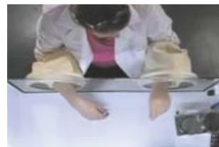
ステンレス製の本体と硬質アクリルガラスにより、頑丈に設計されています。簡易的なチャンパーとは違い、作業時も揺れることがなく、安定した環境で作業可能です。
