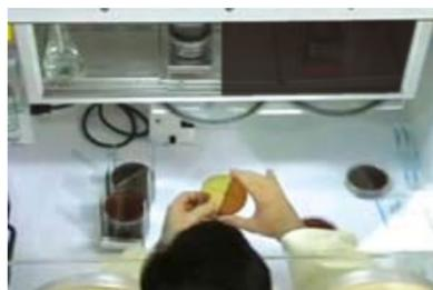
従来のグローブ式とは異なり腕を直接挿入できるため、手先を使った作業性に優れているだけでなく、グローブ式のようにグローブと腕の間に汗が付着することがないため、あらゆる面で作業時間とストレスを削減可能です。
