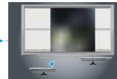
アームポートドアを培養庫下の収納部に収納し、作業スペースを確保します。(バクトロン600除く)
