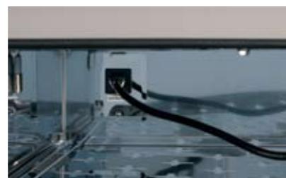
チャンバー内での各種機器の使用を可能にする内部電源コンセントを設置。
