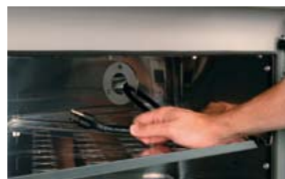
温度測定センサーの設置など、外部との接続が可能なアクセスポートを設置。
