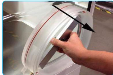
アームポートは人間工学に基づき作業がしやすいように楕円状に設計されています。作業終了時には内部から密閉できるアームポートドアも付属しており、嫌気性を確保できます。
