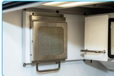
作業開始時にわずかな酸素が混入した場合でも、チャンバー内の水素と触媒カートリッジ内のパラジウムが混入した酸素と反応することで水蒸気化し、結露制御機能を通して処理されます。
